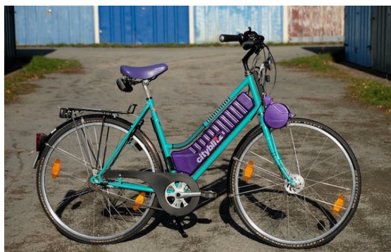
図-4 トルクセンサーを持たない“Pedelec” (ドイツ Diamant 社の City-Blitz 1992・谷田貝一男氏提供)
