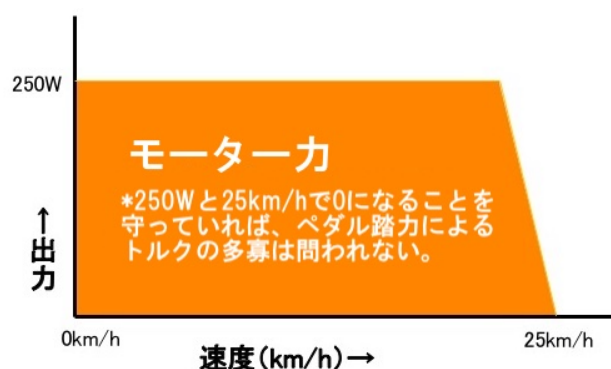
図-6 欧州の電動アシスト率イメージ図(筆者作成)
