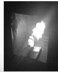
廃グリセリン7:水3での高温燃焼 状況
