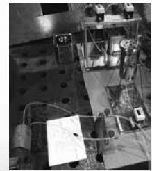
簡易直前混合燃焼実験装置
