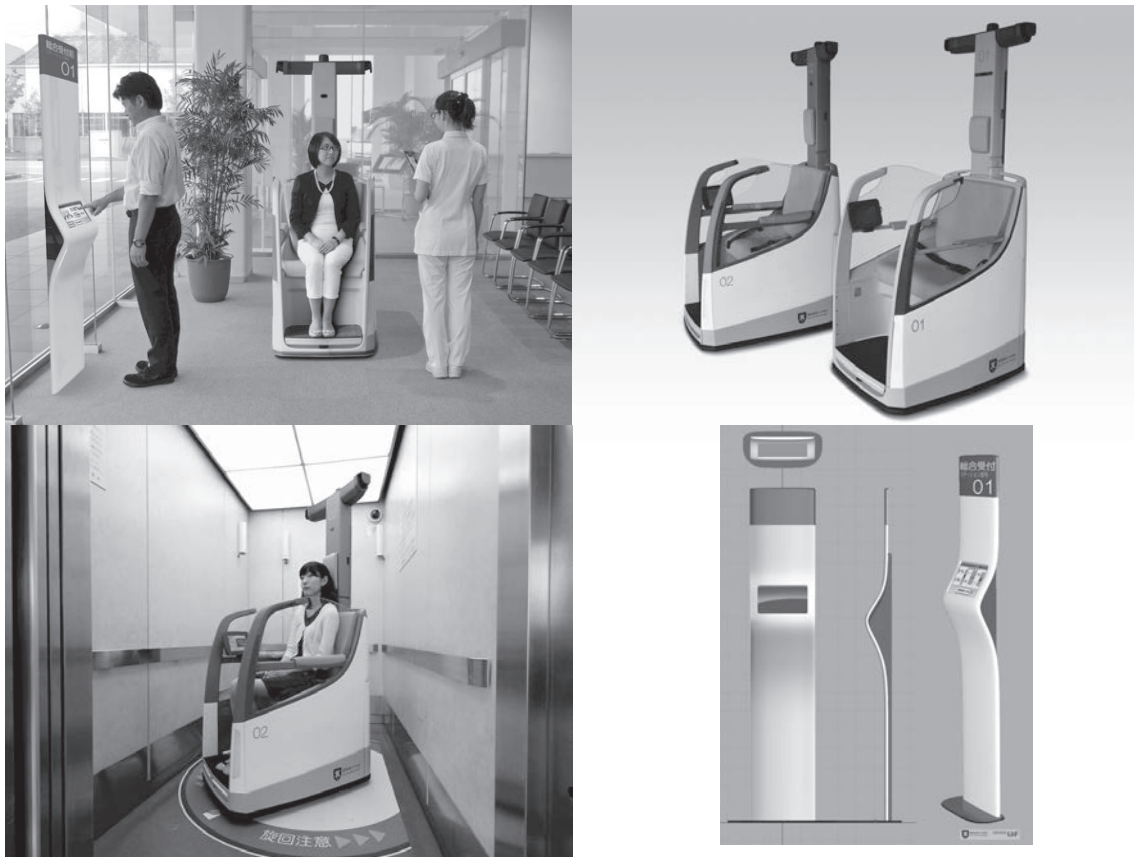
図 12 筆者が並行して試作した自動運転機能付の電動患者搬送システム
