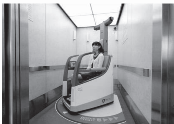
図2 今回試作した自動運転機能付き小型電動車
